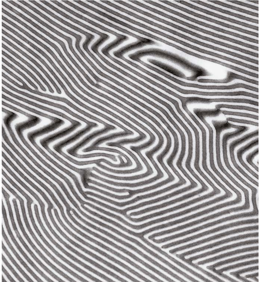
▲ Styrene-butadiene block copolymer x 25'000 Ronald Walter, BASF Aktiengesellschaft, Polymer Physics, D-67056 Ludwigshafen.
